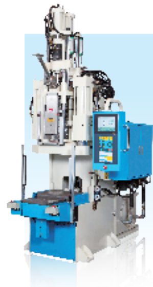
■ 無柱式 - 雙射機 Non-post double injection machine 雙色一次成型，三面空間更便於嵌入及取出的自動化設備安裝。 Double color injection. Three-side open space makes removing and insert of automation equipment easier.
